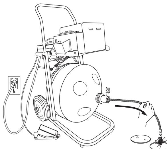
※ヘッドが障害物に食い込みワイヤーが引き戻せない場合は、スイッチを逆回転に入れ、少しずつワイヤーを引き戻しますと、ヘッドが障害物から抜けて引き戻せます。
