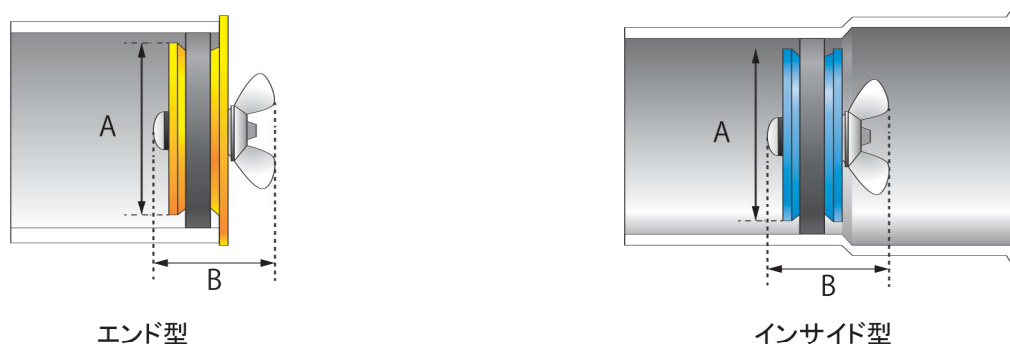
図3-1 メカニカル・プラグ設置例 (A・Bはプラグサイズ)
